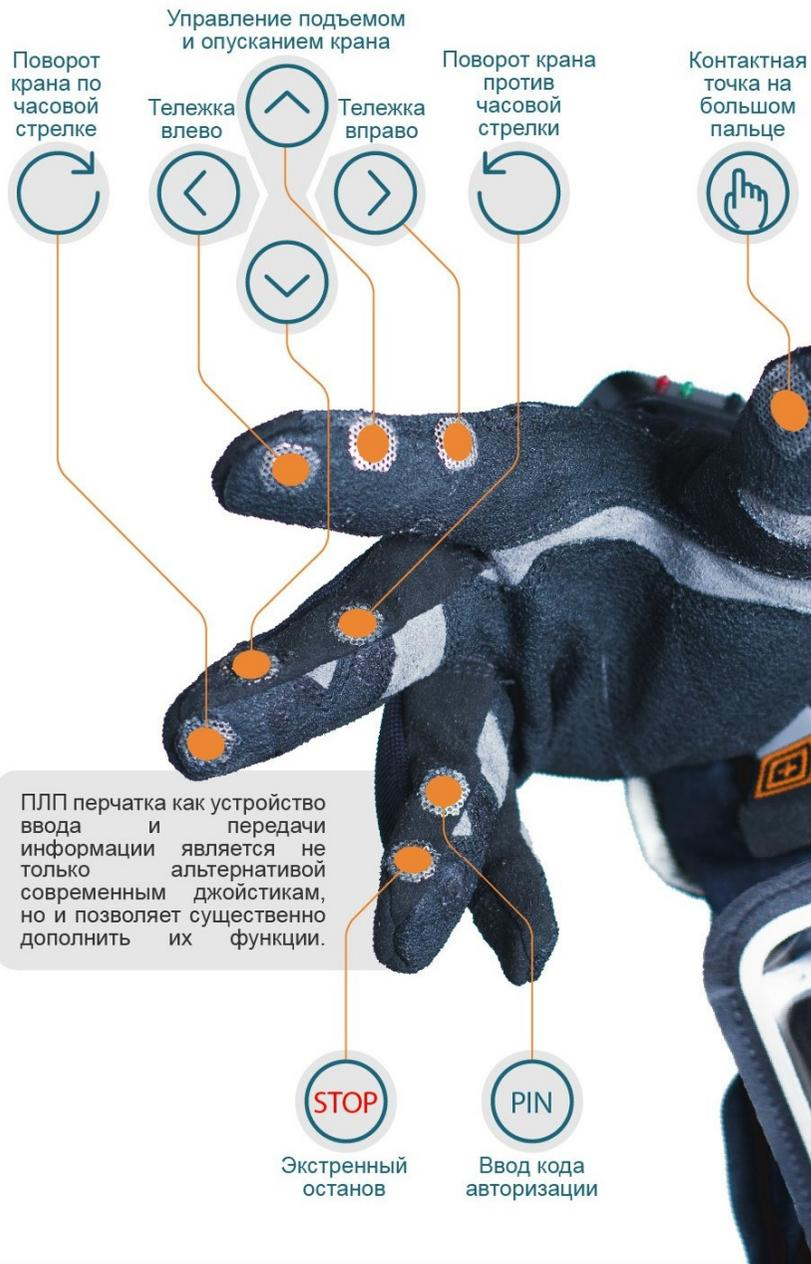
Суть работы данного устройства заключается в том, что функционально для управления краном используются 8 контактов, расположенных на фалангах пальцев. При этом предусмотрена возможность назначать каждому контакту свое управляющее воздействие. С целью безопасности и защиты от случайного соприкосновения контактов фалангов с контактной площадкой большого пальца площадки располагаются на тыльной стороне перчатки.
