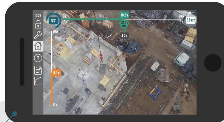
Для управления и слежения за объектом автоматизации дистанционно в реальном режиме времени система оснащается мобильным мини-монитором (смартфоном), который крепится как часы на запястье руки и на котором, через систему связи WiFi, отображается запрашиваемый видеопоток с установленной на кране камеры а также основные параметры работы крана (высота подъема груза, текущее положение и состояние механизмов, ограничение веса, скорость ветра и т.д.).
